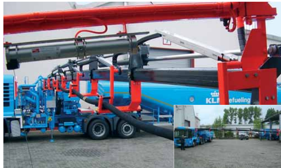
E2/000 seria 1400 w samochodzie do tankowania samolotów; teleskopowy wysięgnik z sześcioma sekcjami
